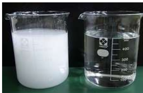
本装置により生成したマイクロバブル水（左）と水道水（右）
