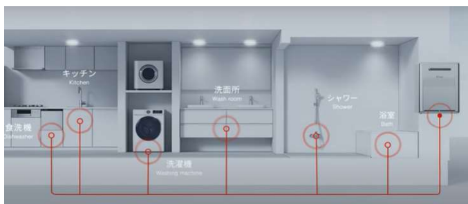
給湯器を通じて家じゅうの水道からウルトラファインバブルを発生
