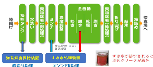
板海苔製造工程とすき水の再生処理
