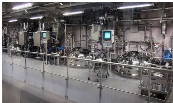
CIP洗浄対象になる製造釜
